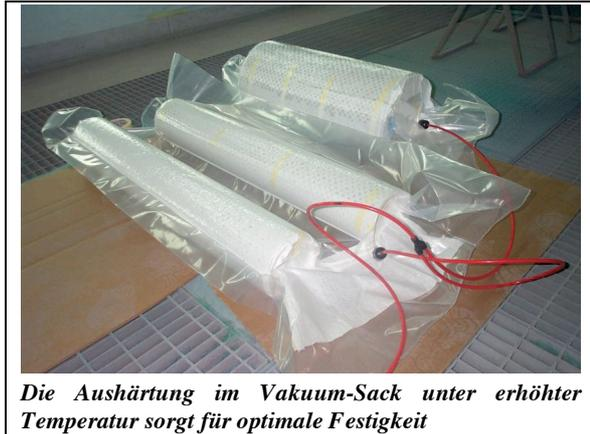
*Die Aushärtung im Vakuum-Sack unter erhöhter Temperatur sorgt für optimale Festigkeit*
