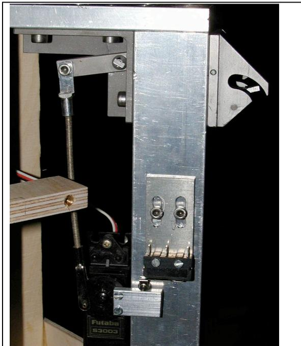
**Rückmeldung der erfolgten Booster-Verriegelung über Endschalter an den Zentralcomputer (Flury)**
