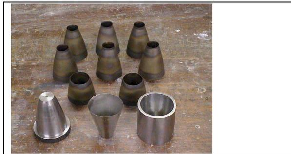
Viele der originalgetreuen Anbauteile wurden in GFK-Formtechnik hergestellt. Dazu gehören die Spitzen der Hauptrakete und aller Booster, die seitlichen Motorverschalungen, Heckblenden und Ähnliches. Selbst die flexiblen, aus feuerfestem Stoff gefertigten Schutzverpackungen der Raketenmotoren wurden originalgetreu nachgebaut.
