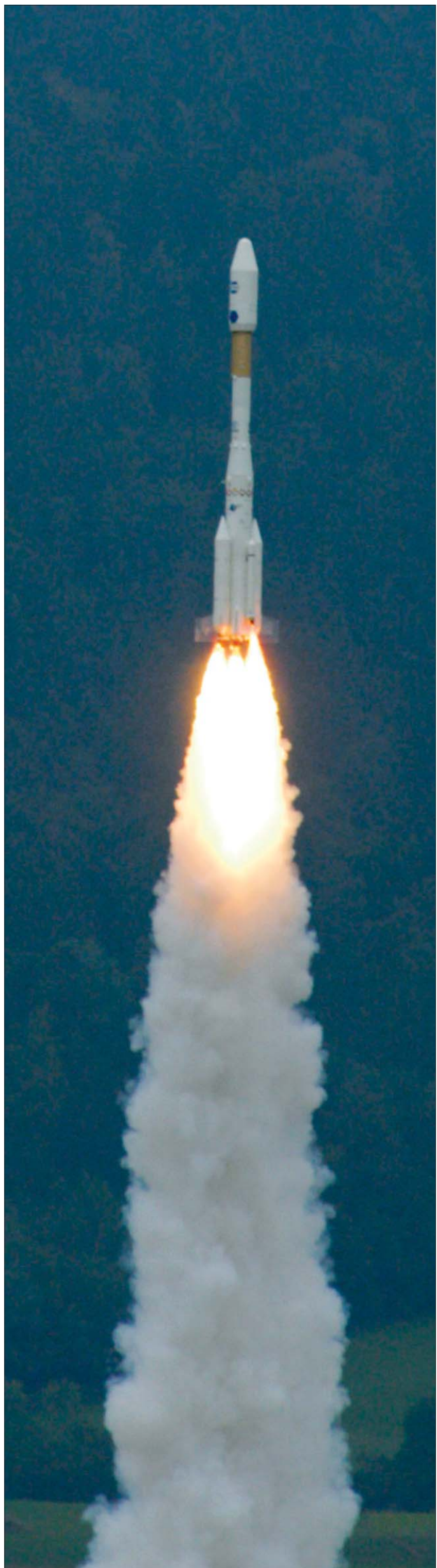
Auf Knopfdruck verwandelt sich Treibstoff im Wert von 1000 Euro in eine Orgie aus Feuer, Rauch und Lärm und treibt das viereinhalb Meter große und eineinhalb Zentner schwere Modell der Ariane 4 auf 900 Meter Höhe. Fast 7000 Euro Materialkosten stecken in der größten Modellrakete Europas. Fotos: Peter Gisder
