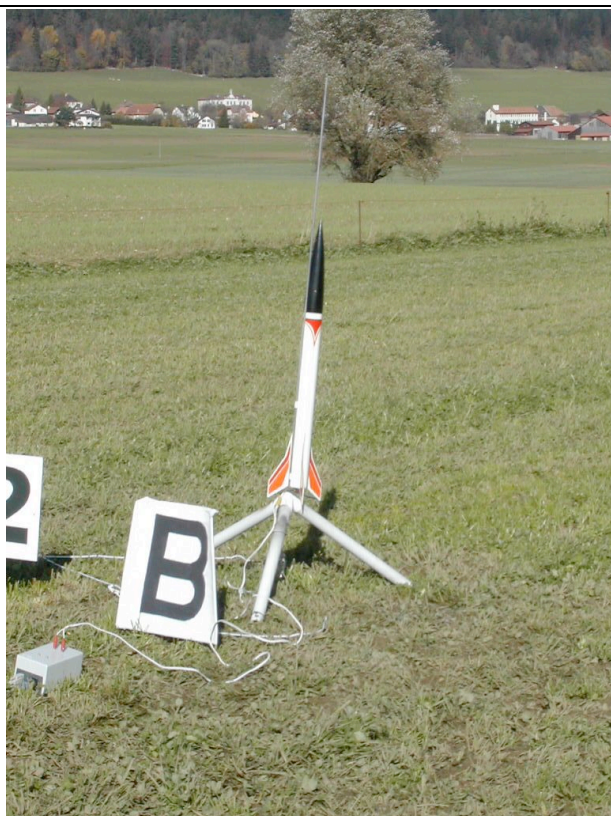
Aerotech Initiator – Länge ca. 800mm, Gewicht 450g, Motoren E16 bis G80, Flughöhen bis 600m, klassische Rakete für den Einstieg in den MPR-Bereich, Recovery (Bergung) über eine Verzögerungs- und Ausstossladung im Raketenmotor.
