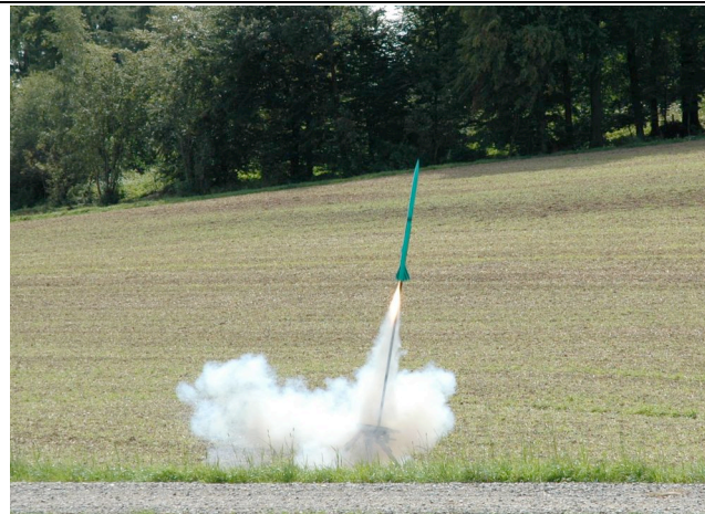
Start einer umgebauten Aerotech Arreaux auf einem F40W ohne Ausstossladung. Bergungssystem über einen Höhenmesser: sobald die Rakete nicht mehr steigt, wird der Hilfsschirm ausgestossen; auf einer definierten Höhe (150m) der Hauptschirm. Nutzlast: Aiptek PenCam VGA 400.
