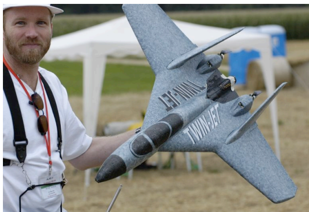
Auch das ist möglich: Twin Jet (EPP-Modell von Multiplex, Antrieb mit zwei SPEED 400 bzw. 480er-Elektromotoren). Und natürlich ein Booster: Aerotech F16RCJ
