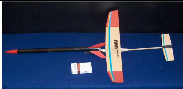
Boost Glider: Der Balsagleiter wird durch die negative Beschleunigung beim Fallschirmausstoss ausgeklinkt. Ziel ist, dass er möglichst lange in der Luft bleibt. Der Booster landet an einem Fallschirm oder Strömer (Flutterband). Hier wurde ein käuflicher Balsagleiter (Graupner Mini-Uhu) umgebaut. Treibsatz C6-3, Flughöhe ca. 150m, Flugzeit etwa 20s.
