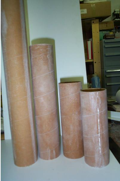
*Abb6. 2.5“ Rohre geglast und grob verschliffen*
